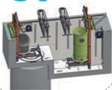
Zerlegung der Reaktoreinbauten, Ansicht Reaktorbecken, 30 %-Design
