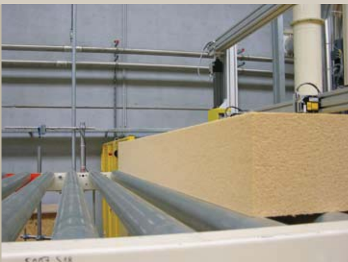
Holzfaserdämmplatten erzeugt nach einem Trockenverfahren von Siempelkamp
