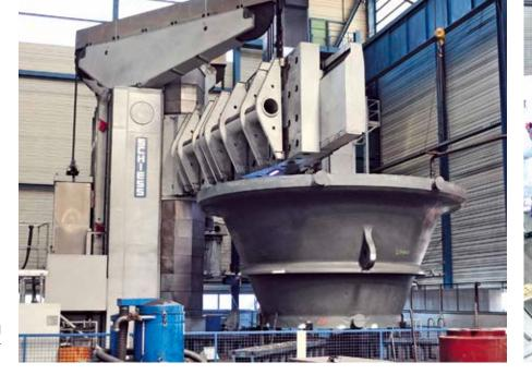
Lösche grinding bowl on Vertimaster
