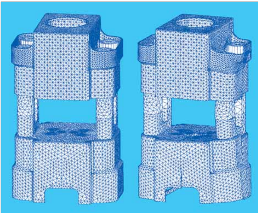
Bild 5: FEM-Gesamtnetz der Fliesenpresse nach Bild 4; links: unverformt, rechts: durch den Preßvorgang hervorgerufene Verformungen, überhöht dargestellt in einem Viertelsektor
