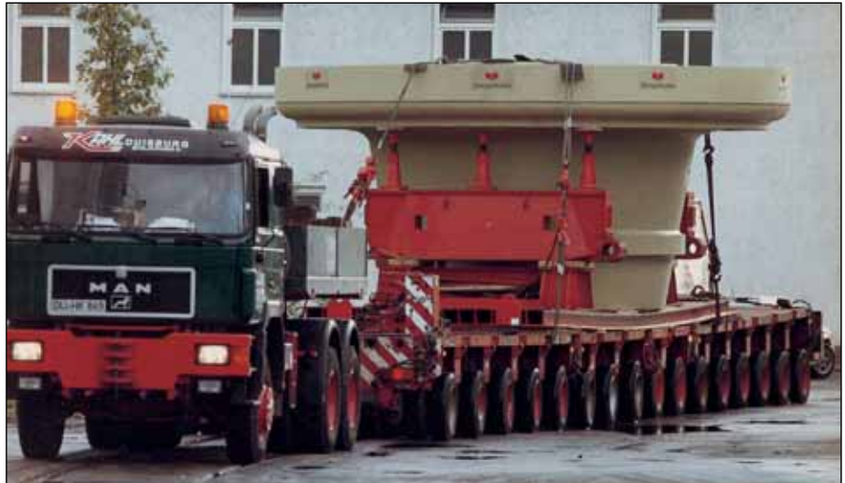
Bild 12: Mahlschüsseln für Zement werden heute einteilig mit Stückgewichten von über 200 t aus EN-GJS-400 gegossen
