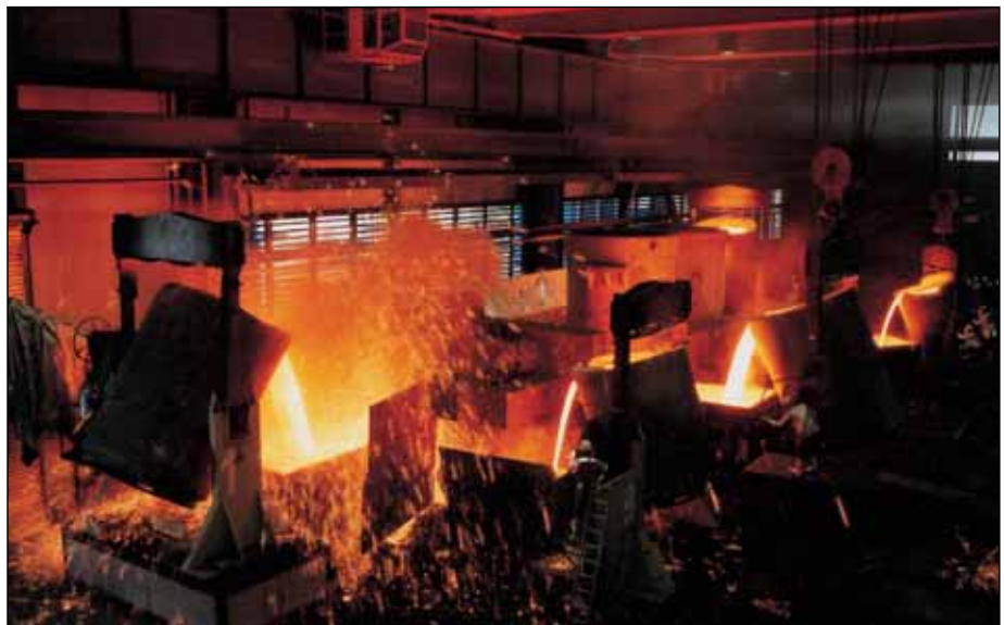
◀ Bild 13: Laufholm aus EN-GJS-400 für eine O-Pressen, Gewicht: 245 t; der Abguß dieses Laufholms erfolgte gleichzeitig aus fünf Pfannen. ▼
