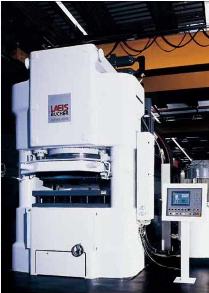
◀ Bild 4: Fliesenpresse mit einer Preßkraft von 42 MN (4200 t) mit einem nach den Bildern 5 und 6 optimierten Ständer aus EN-GJS-400 (Bild: Laeis Bucher, Trier)
