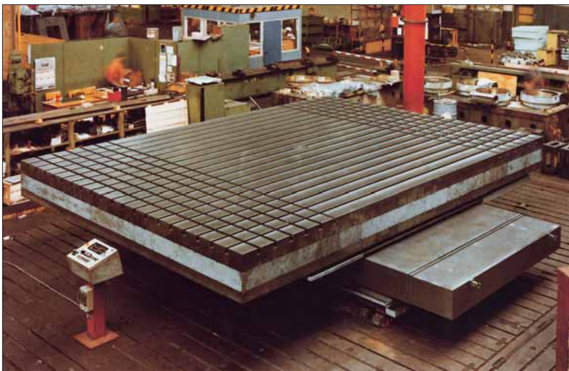
◀ Bild 7: Aufspanntisch für eine Werkzeugmaschine; Abmessungen: 5000 × 6000 mm, Gewicht: 72,7 t, Werkstoff: EN-GJS-600
