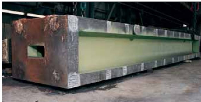
◀ Bild 13: Laufholm aus EN-GJS-400 für eine O-Pressen, Gewicht: 245 t; der Abguß dieses Laufholms erfolgte gleichzeitig aus fünf Pfannen. ▼
